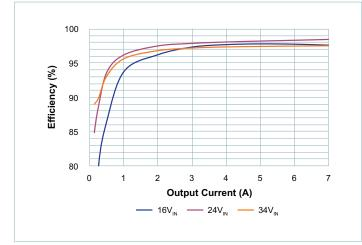
Figure 1 — 24V<sub>OUT</sub> Efficiency
