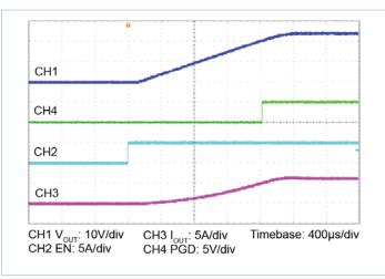
Figure 10 — Start-up with 24V<sub>IN</sub> to 24V<sub>OUT</sub> at 5A
