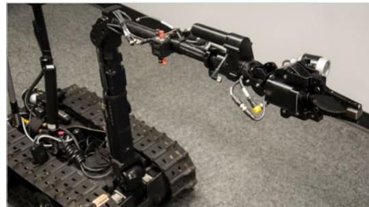
除了要能携带比之前的设计更重的有效载荷（包括各种功能增强而复杂的电子部件，比如传感器、摄像头、传播工具以及通信与控制部件）之外，他们还要求该机器人更小更轻，方便将它轻松地部署到远程作业点；并且要足够坚固稳定，以适应各种地形。考虑到远程操作、任务的错综复杂以及故障风险，数据传输速度、传感器精度以及影像品质都变得特别重要。对电源 EMI 的管理是一个基本要求。
