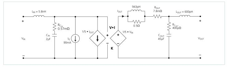
Figure 16 — VI Chip<sup>®</sup> module AC model
