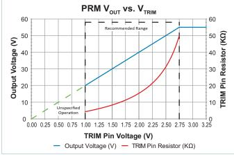
Figure 26 — PRM V<sub>OUT</sub> vs. V<sub>TRIM</sub>
