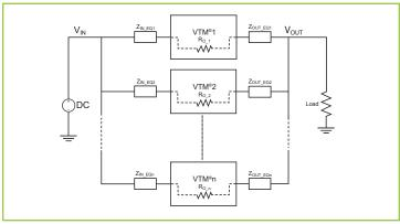
Figure 20 — VTM module array
