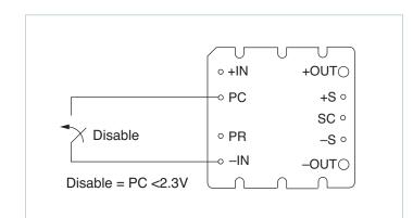
Figure 2 — Module enable/disable
