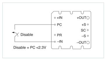
Figure 2 — Module enable/disable
