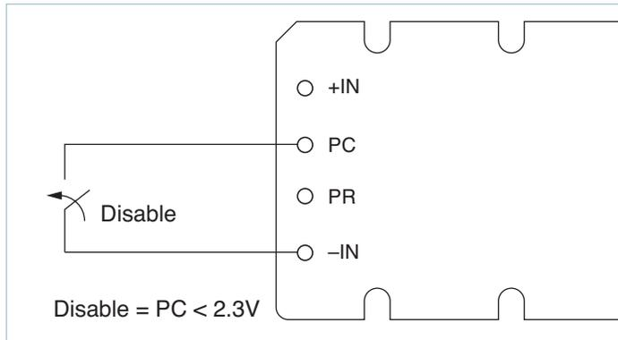
Figure 2 — Module enable/disable
