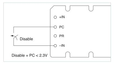
Figure 2 — Module enable/disable
