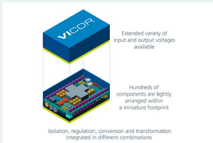
圖 2：簡單的模組化方法不僅靈活，而且可輕鬆擴充，優化供電網路所需的專業知識較少。
