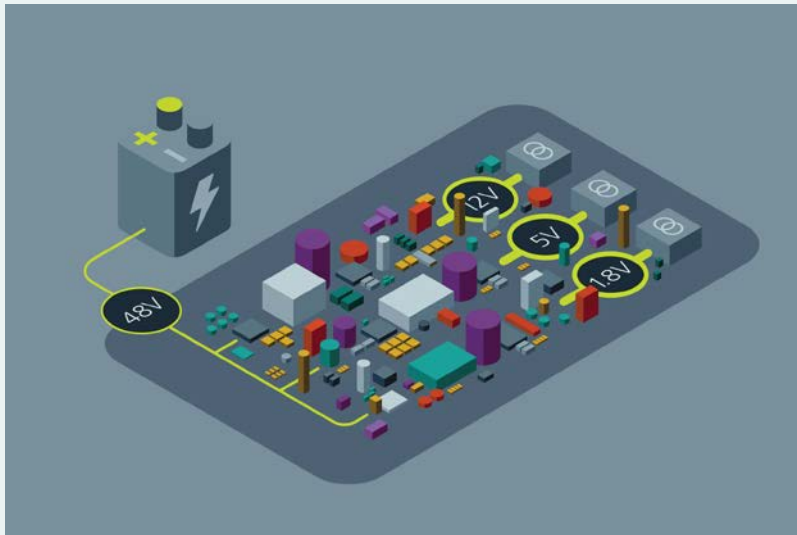
圖 3：離散式解決方案有更多的組件需要管理，新增了設計複雜性。
