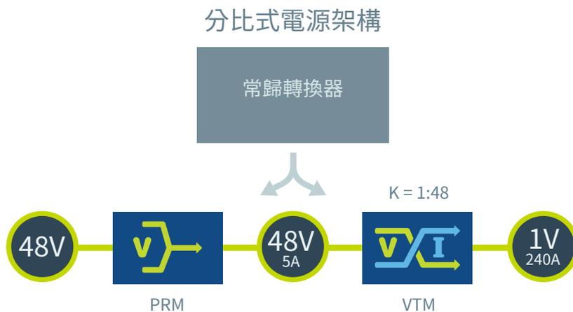
圖7：分比式電源架構™ 將兩模塊分離，分別用於穩壓和電流倍增，以提高常規轉換器的效能。雙晶片組的概念是針對特定功能進行優化，現已顯著提高了競爭標準優勢。PRM™ 穩壓器經過精準設計，主要為下游 VTM™ 電流倍增器提供嚴格穩定的 48V 母線電壓，而電流倍增器則提供負載高效電壓轉換輸出因數為負載提供所需的輸出。
