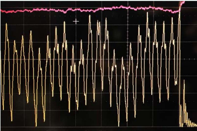
图 8：（上）20ms/div 的 770V 输入端的示波器图像、在 100V/div 时为【红色】、2A/div 的电流【黄色】，通过一个 6kW【峰值 8kW】固定比率转换器加速 48V 电机，显示加速步骤和 PWM 脉冲；（下）100 $\mu$ s/div 的峰值详细信息。
